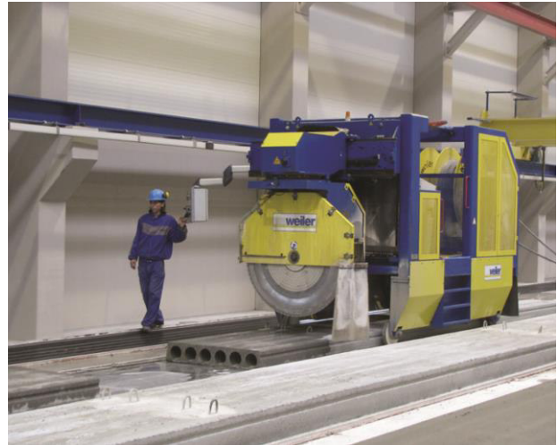
Schneiden auf Elementlänge nach der Produktion auf der 156m Bahn
